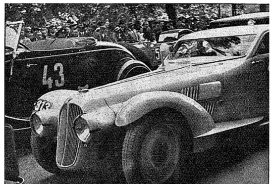
Abb.54a+b: Der „Aero Loch Ness“ von 1934 mit einer vom Aero-Konstruktionsleiter Josef Vorisek gezeichneten Stromlinien-Karosserie. Allerdings muss in diesem Zusammenhang auch erwähnt werden, dass Josef Vorisek ursprünglich einen noch radikaleren Karosserieentwurf mit voll verkleideter Front vorgesehen hatte, der aber anscheinend wegen zu hohem Gewicht verworfen wurde (siehe Abb.59).
