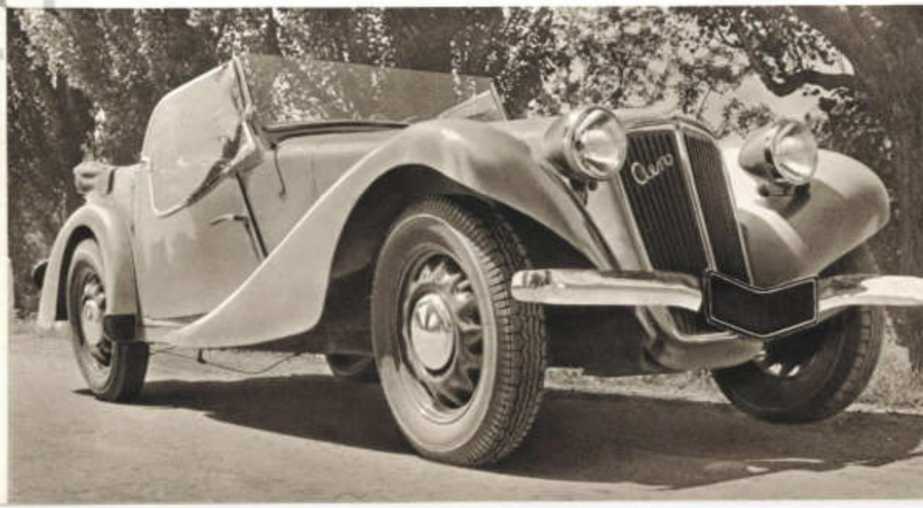
Jedinečné řešení rámu podvozku nám umožňuje umístiti podlahu vozu na spodní hraně tohoto rámu. Nejen tím, ale i širokým rozchodem zabezpečili jsme vozu nejvhodnější polohu těžistě. AERO 30 přes to, že má nízký vzhled, je uvnitř tak prostorný jako málo-který jiný automobil. Všechny důležité orgány jsou oproti jiným vozům umístěny nad ocelovou podlahou, chránící citlivé součásti vozu jako ocelový pancér a zamezujići současně vnikání bláta a vody do vozu.
